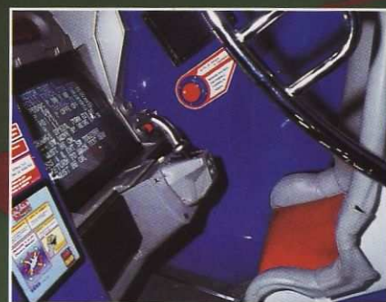
O "cockpit" é equipado com cinto de segurança, trava abdominal e ejetor.
